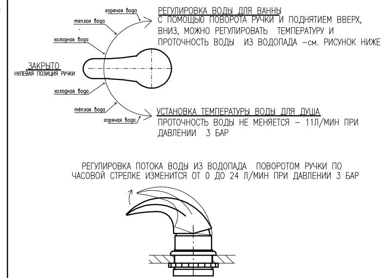
Páčka v poloze NULA uzavírá vodu. Při otáčení páčky VE SMĚRU hodinových ručiček nám začne tечь voda přes výtok (chrlič) do vany. Čím více se budeme oddalovat od nulového bodu, tím teplejší voda se nám bude mixovat (viz obrázek). Na této straně pootočení ještě můžeme regulovat i průtok vody nakloněním páčky nahoru od 0-24l/min při tlaku 3barů.
